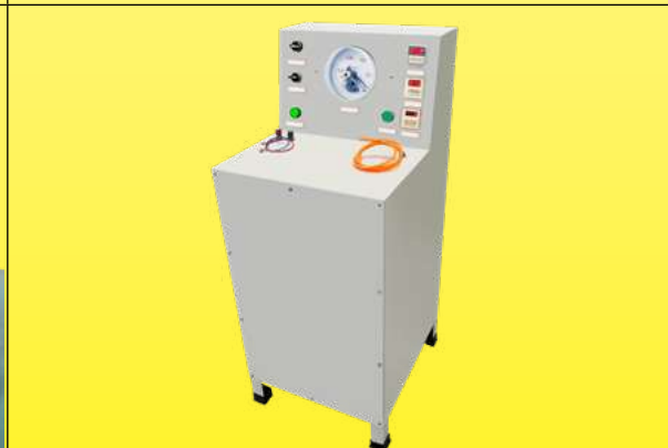
Verifica dei cicli di funzionamento dei pressostati
