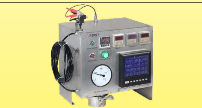
Apparecchiatura di test per misurare ripetutamente e costantemente la lunghezza massima dei tubi di collegamento degli interruttori pneumatici in funzione del volume del pulsante e della pressione che sviluppa (Laboratorio Ultimheat)
