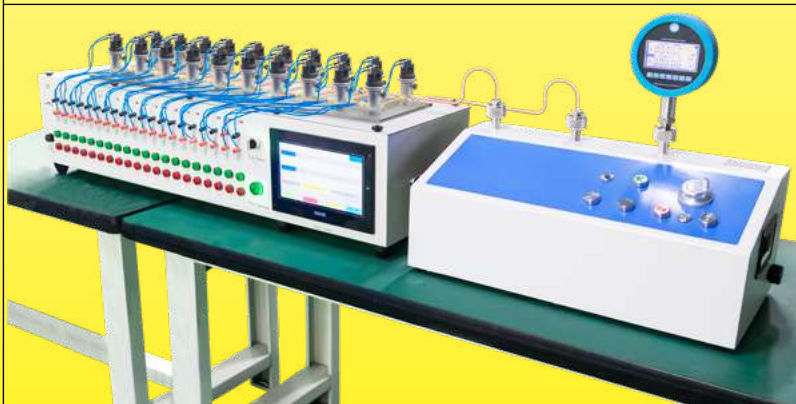
Verifica della calibrazione del pressostato
